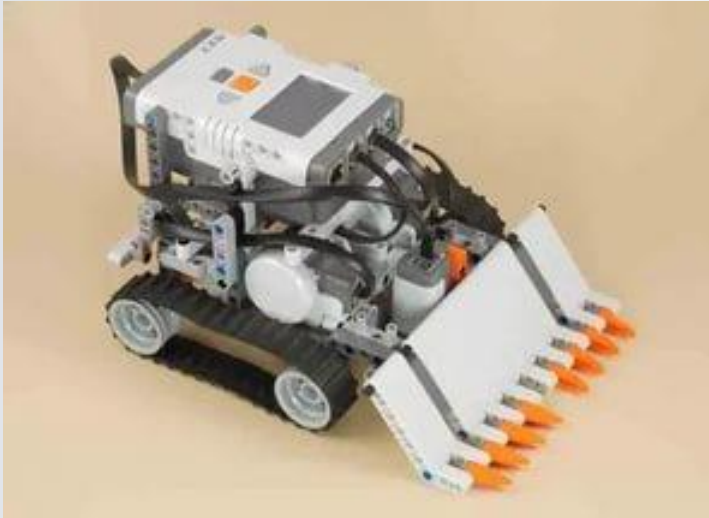
Робот сумо юных техников Усть-Каменогорска на базе Lego
